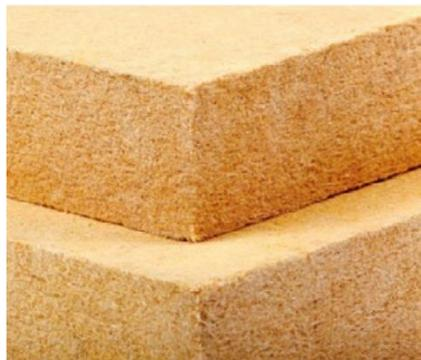
Pannello isolante in fibra di legno prestazionale, densità 150 kg/m<sup>3</sup>, quantità di legno > 90% in peso del prodotto, Spessore pari a 10 cm, conduttività termica dichiarata  $\lambda D = 0,040$  W/(mK), sollecitazione a compressione 80 kPa, assorbimento acqueo ridotto WS 1.0.
